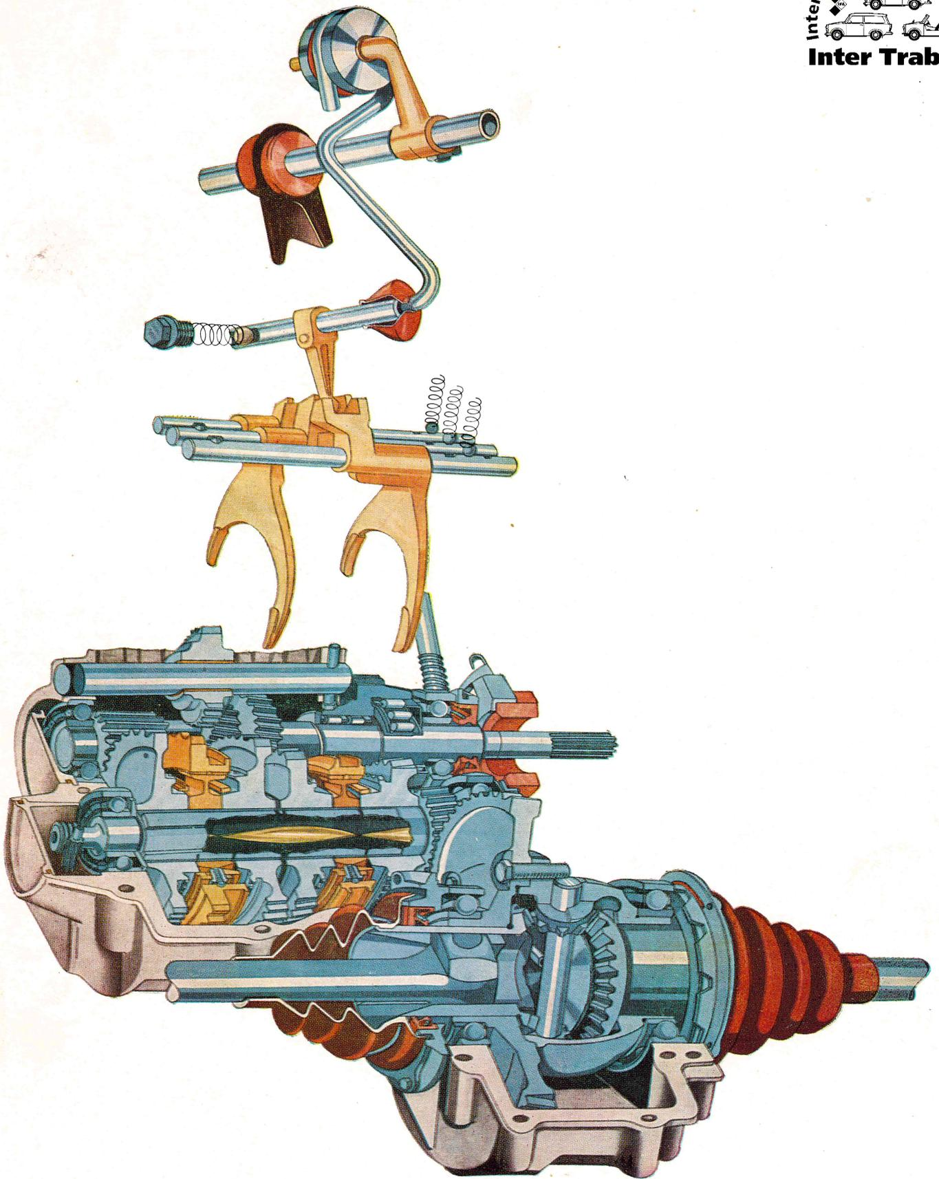
Bild G 1. Getriebe – Schnitt
