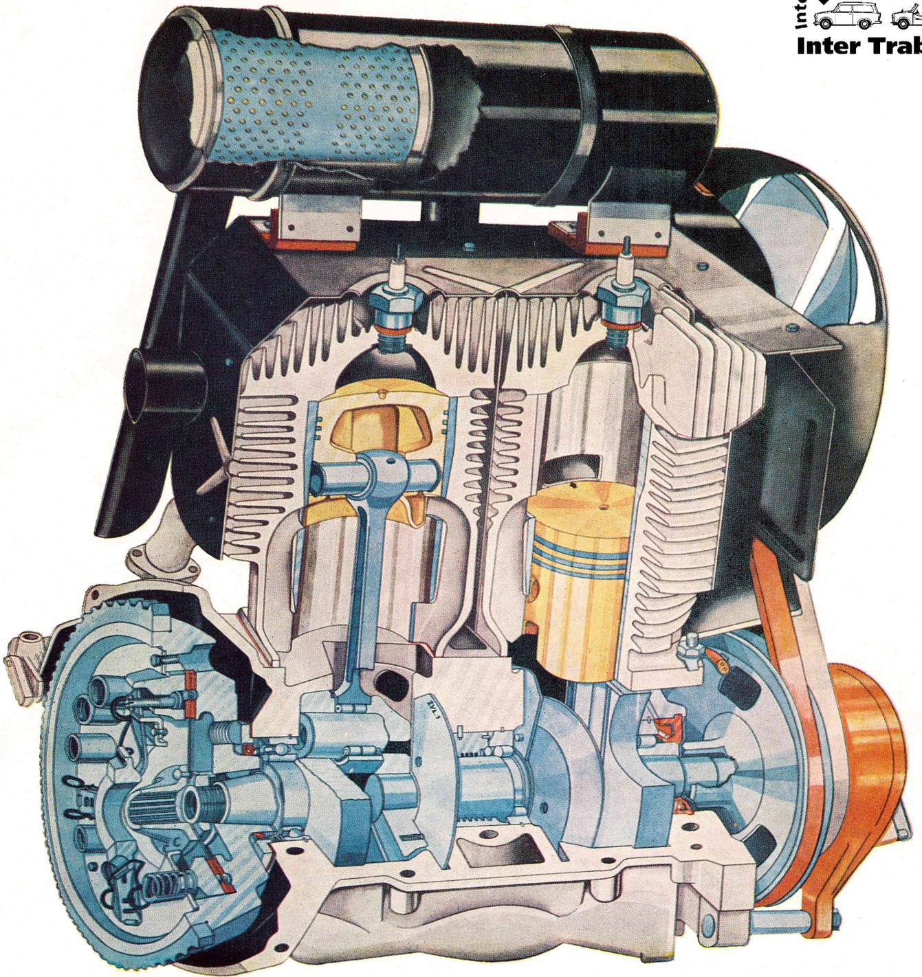
Bild M 1. Motor – Schnitt
